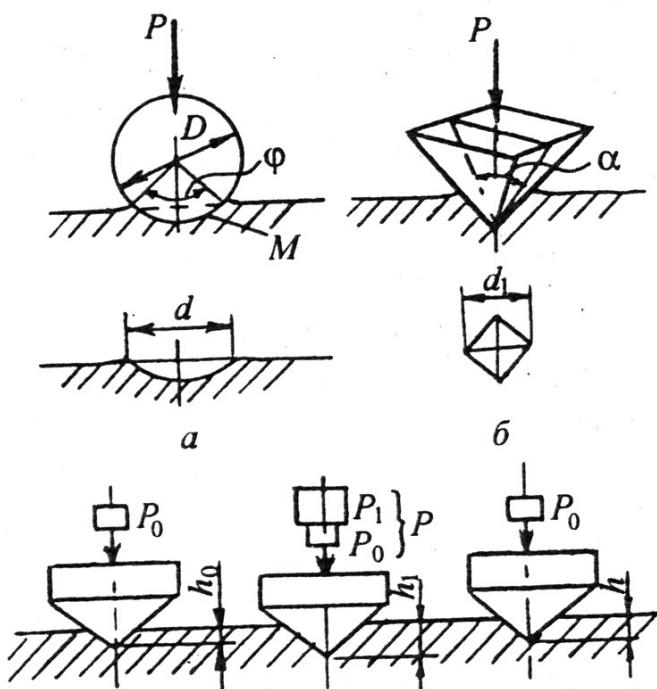
Рис. 1.1 Схемы испытаний на твердость:
