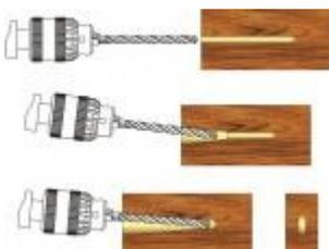
После того как отверстие получено, примерьте к нему хвостовик и при необходимости доработайте или отверстие сверлом/надфилем, или хвостовик на точиле.
