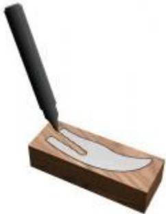
Отрезаем передний торец бруска, проверяем перпендикулярность и выравниваем плоскость, сперва напильником, затем на наждачной шкурке. Шкурка должна быть неподвижно закреплена на какой-либо ровной поверхности. Брусочек нужно держать пальцами как можно ближе к обрабатываемой поверхности. Если держать брусочек высоко, и/или не закрепить шкурку, то есть, при обработке брусочек будет «гнать» перед собой волну, обрабатываемая поверхность получится сферической.
