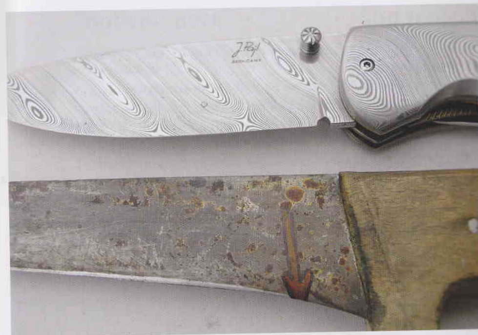
Břit nelze naostřit až do konce, ostří je nepravidelné a hrubé
