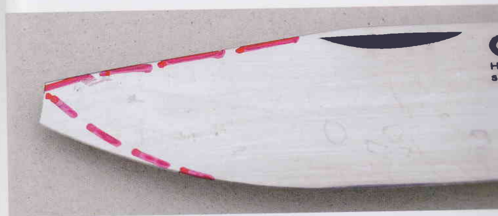
Ulomený hrot čepele zavíracího nože
