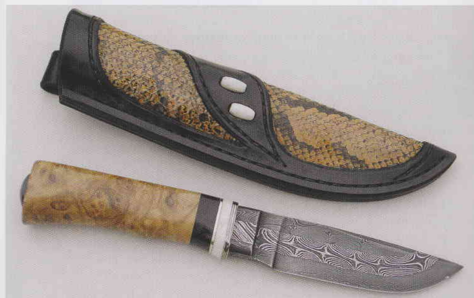
Nůž Nixx, čepel tvoří 3 damaškové pruty svařené svíse na sebe, horní je torzní, střední torzní s niklem a spodní prut tvořící ostří je vrstvený
