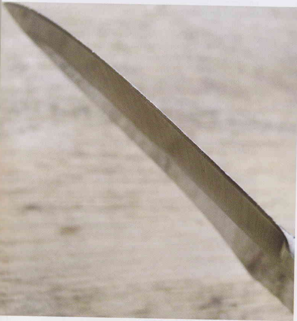
Nepravidelná ploška na ostří znamená otupení – ostří „svítí“
