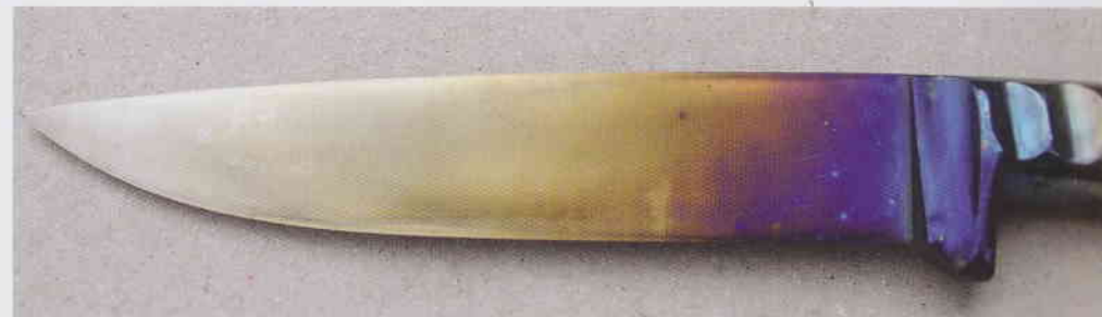
Změna barvy čepele vždy signalizuje změny jejích vlastností
