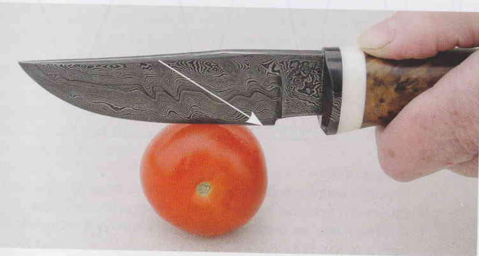
Řez tahem vlastně zmenší úhel břitu a působí i „pilovitost“ ostří
