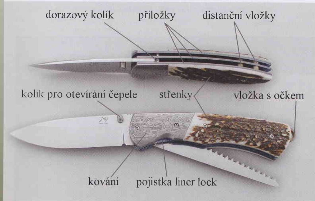
Popis nože s pojistkou liner lock
