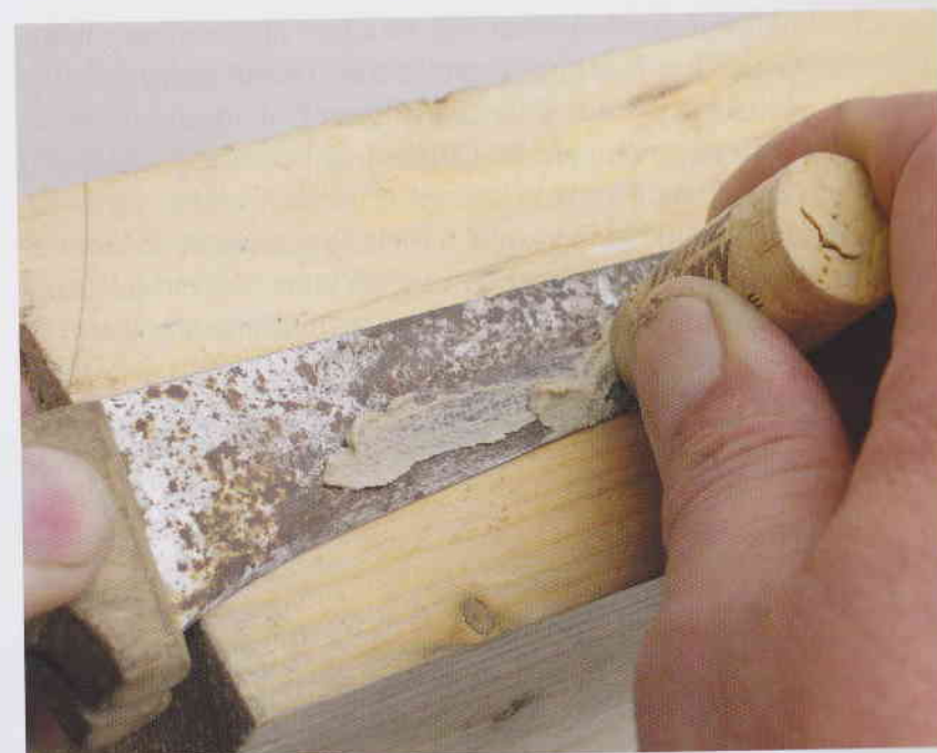
Cídění čepele nože
