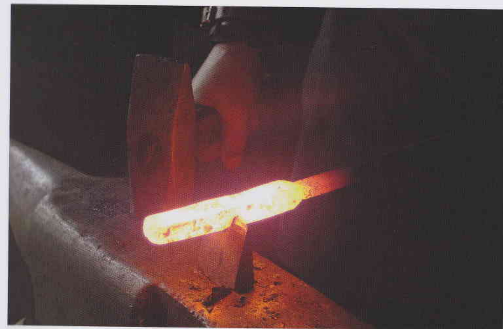
Nasekávání svařeného polotovaru
