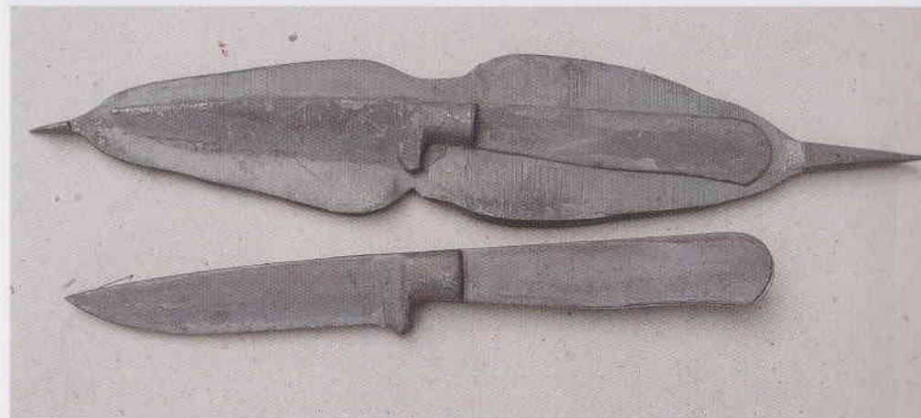
Hrubý a ostřížený polotovar pro zavazák vyrobený kovářím v zápustce
