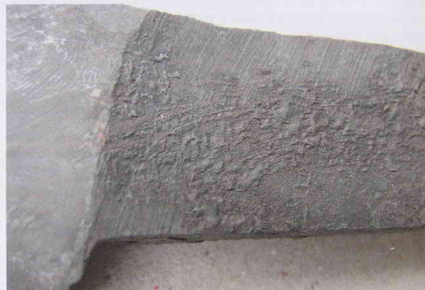
Vrstva okují na polotovaru budoucí čepěle
