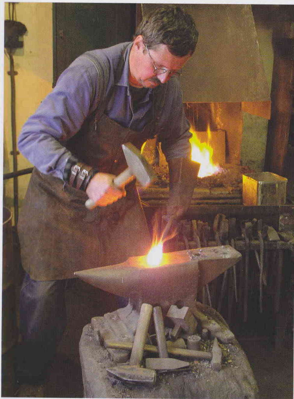
Vykování damaškového polotovaru do tvaru čepele
