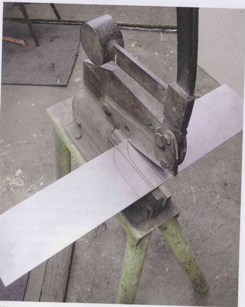
Dělení materiálu na pákových nůžkách
