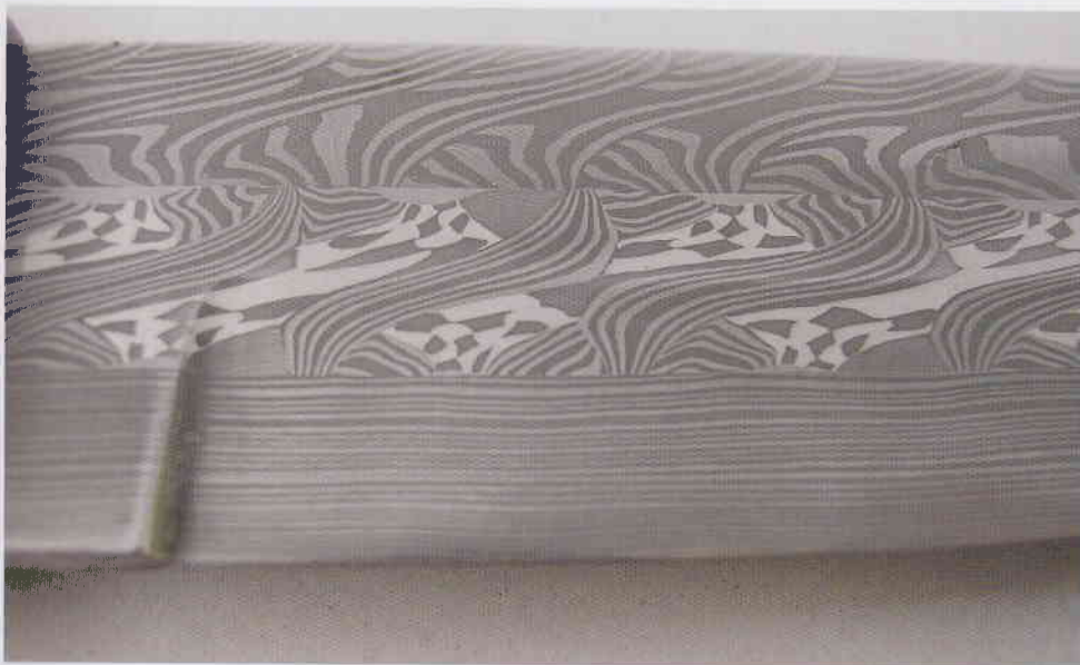
Detail čepele z mozaikového damašku, střední prut zvýrazněn přidáním niklu
