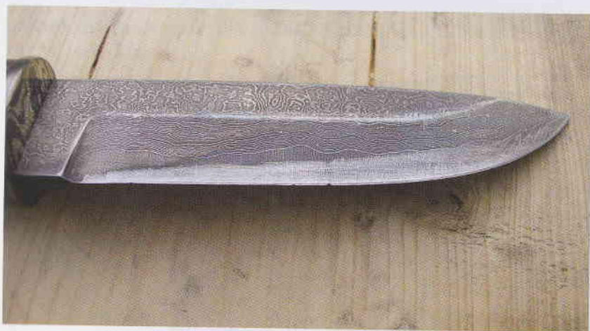
Tento nůž z damascenské oceli byl při pečení selete ponechán blízko ohně a vyhrát, o čemž svědčí modré zabarvení čepel a ztráta její tvrdosti
