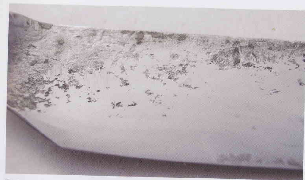
Zbytky okují na povrchu čepel
