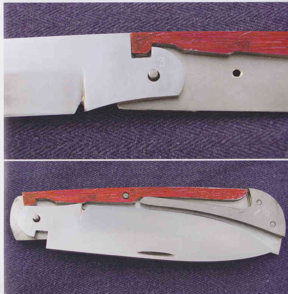
Detail rozebraného nože – funkce hřbetní pojistky (nahore)
