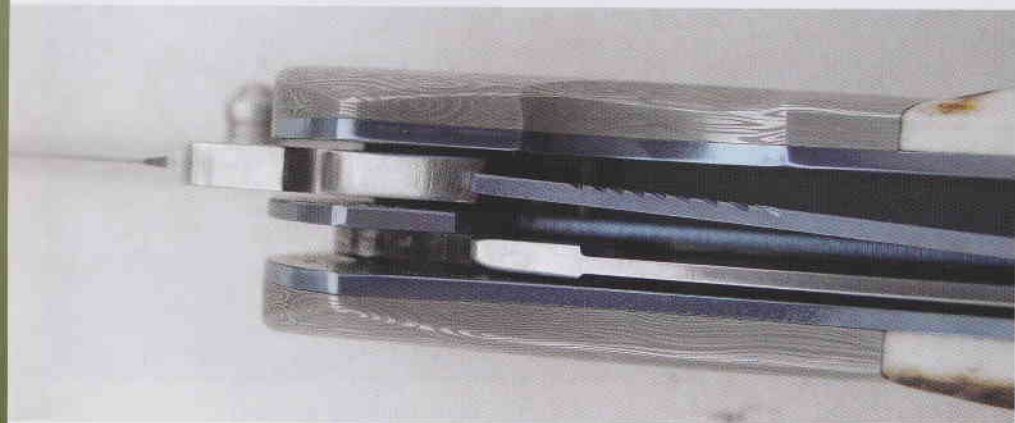
Detail pojistky liner lock
