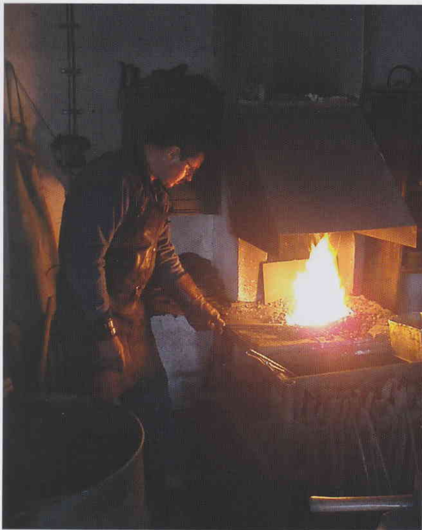
Zahřátí paketu na svařecí teplotu
