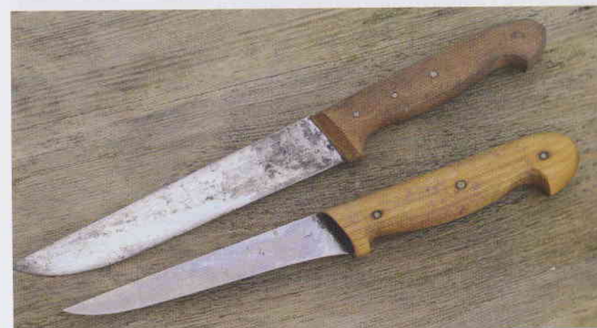
Řeznické nože z uhlíkaté nástrojové oceli „drži“ ostří
