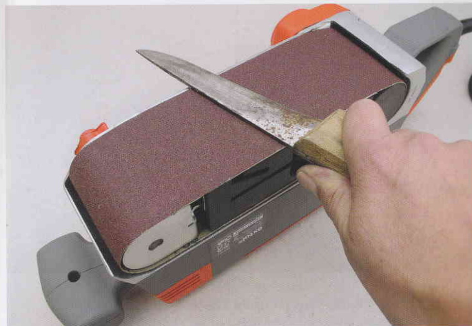
Broušení na ruční pásové brusce
