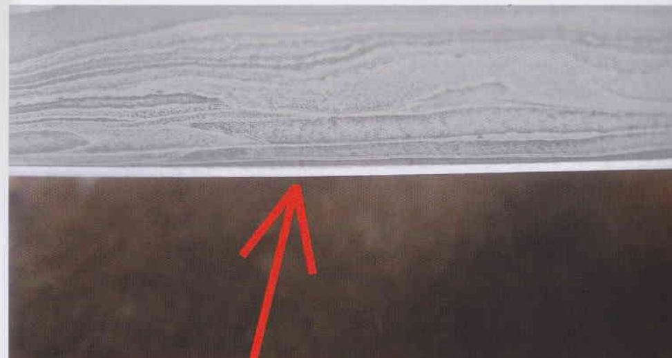
Vlastní řezné ostří je tvořeno ploškou-fasetou
