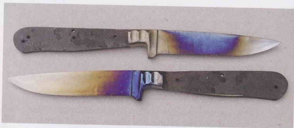
Popouštěcí barvy v „reálu“ na čepelích zavazáku
