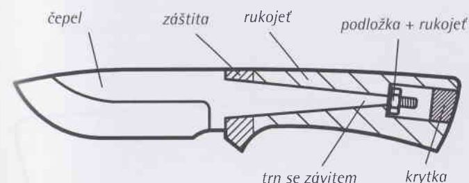
Pevný nůž se stopkou – trnem (nahore) Hlavice kryjící montáž
